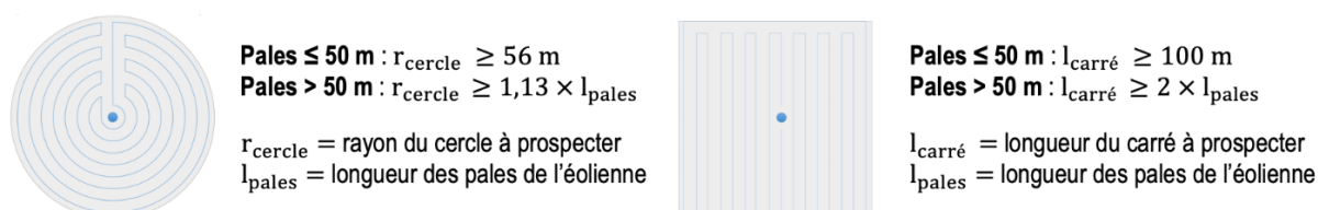
Figure 1 : Schémas des surfaces théoriques de prospection
