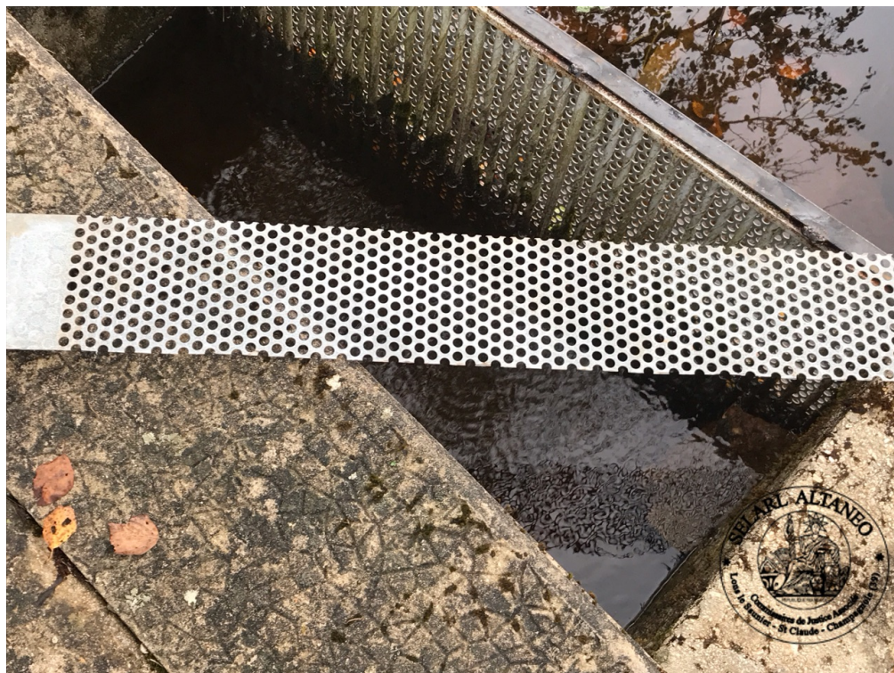
12. Vue d'un échantillon de la grille en galvanisé perforé (10:33:44)
