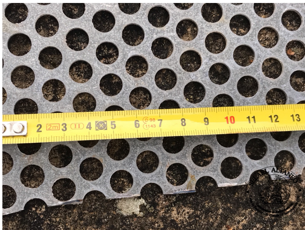
13. Vue d'un échantillon de la grille en galvanisé perforé avec diamètre et espacement des trous (10:35:13)
