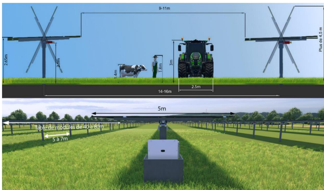
Figure 9 : Modélisation de l'installation agrivoltaïque
