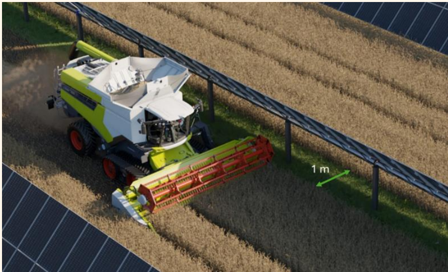
Figure 17 : Localisation de la perte de surface en bords des poteaux
