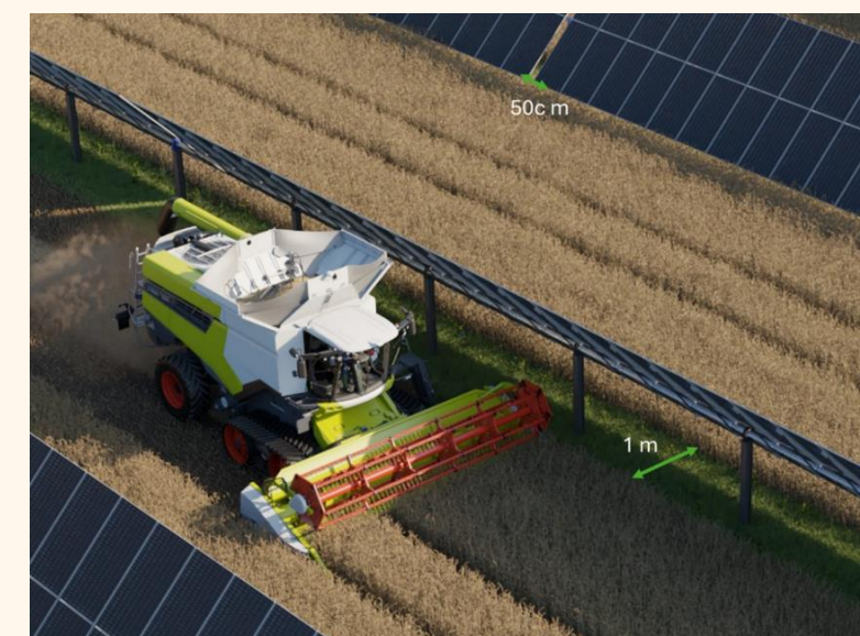
Figure 15 : Localisation de la perte de surface en bords des poteaux
