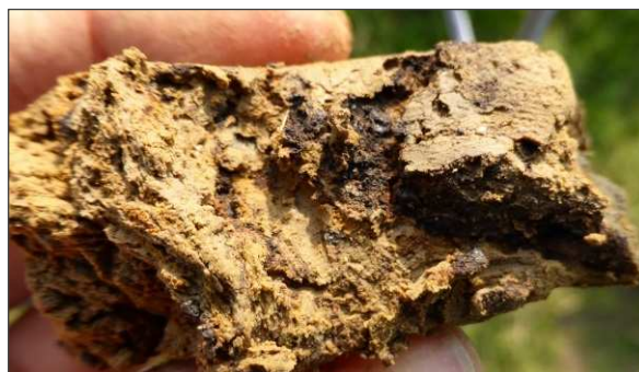
Exemple de traces d'hydromorphie (concrétions ferro-manganiques)
