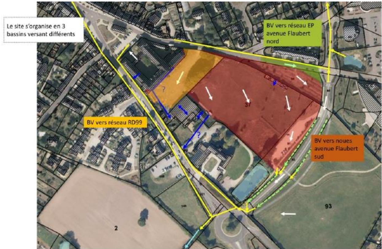
Figure 41 : Fonctionnement pluvial du site (Source Iao Senn)
