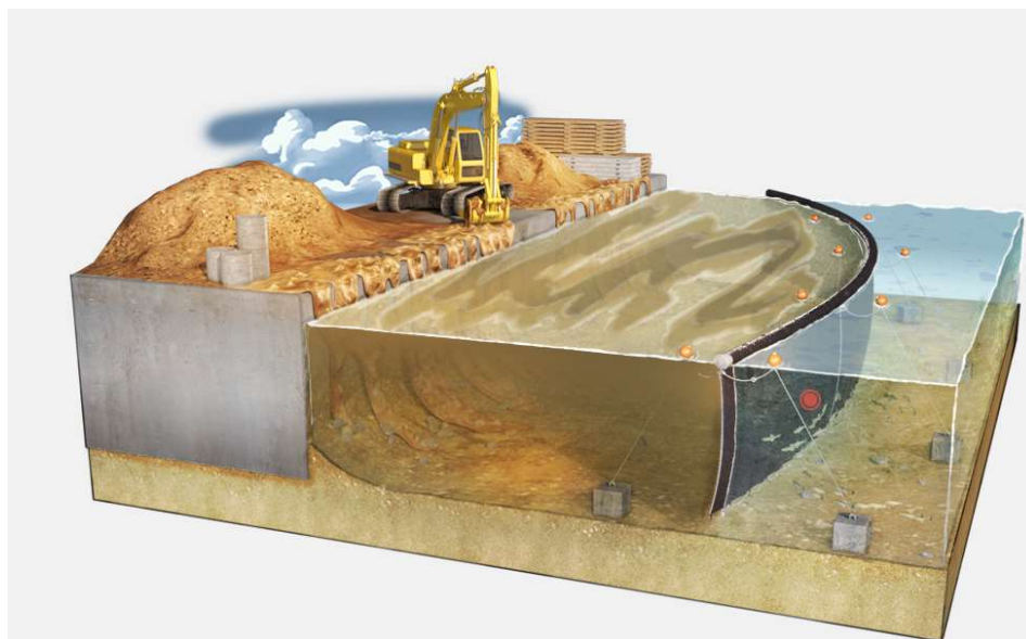
Figure 72: Exemple d'un rideau de confinement anti-dispersion des sédiments en suspension en milieu hydrique (ACE Geosynthetics)
