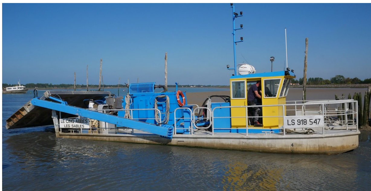
Figure 7 . Rotodévaseur « Le cinq Abbés » utilisé dans l'estuaire du Lay (source : service portuaire de L'Aiguillon-La-Presqu'île)
