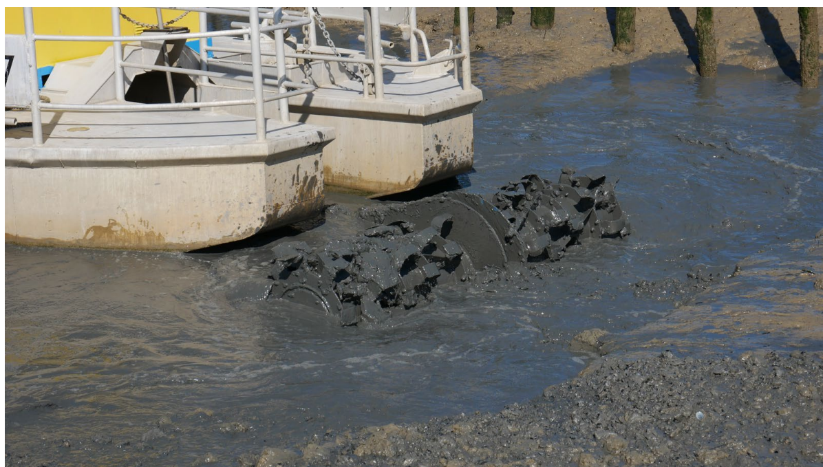
Figure 8 . Rotodévaseur « Le cinq Abbés » utilisé dans l'estuaire du Lay : fraise horizontale (source : service portuaire de L'Aiguillon-La-Presqu'île)
