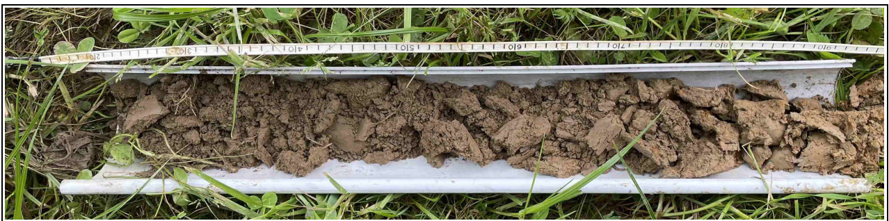
Illustration 4: Profil du sondage 2 (non humide), trace rédoxique à partir de 25 cm de sol et intensification avec la profondeur
