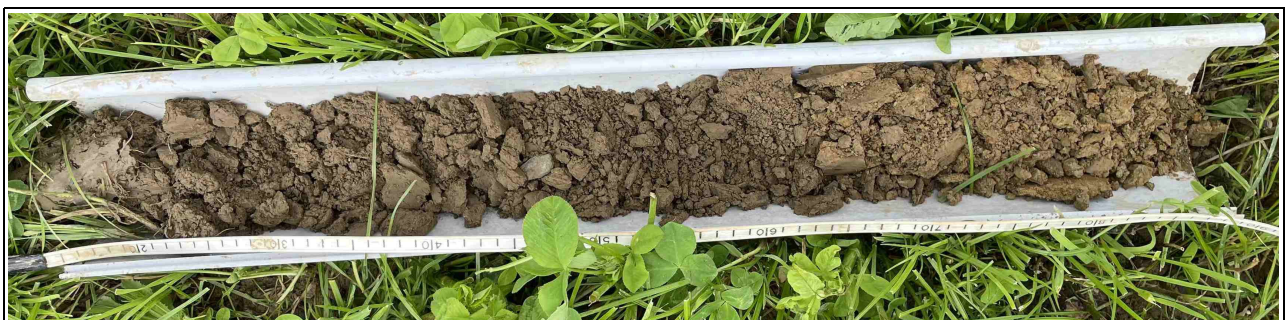
Illustration 6: Profil du sondage 3 (non humide), trace rédoxique à partir de 25 cm de sol et intensification avec la profondeur
