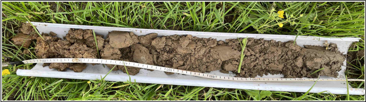
Illustration 3: Profil du sondage 1 (non humide), trace rédoxique à partir de 25 cm de sol et intensification avec la profondeur
