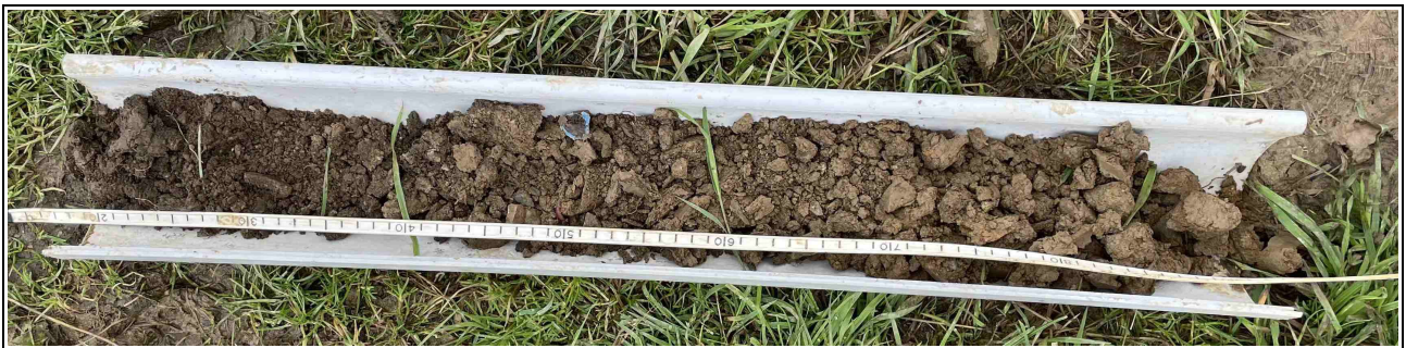
Illustration 5: Profil du sondage 4 (non humide), trace rédoxique après 25 cm de profondeur et intensification avec la profondeur
