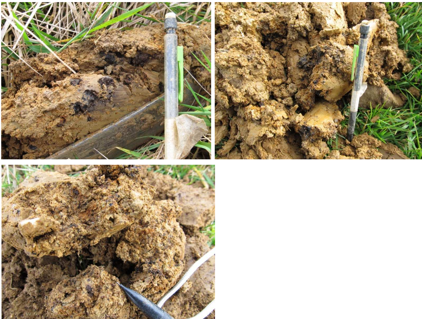
Figure 3 : Horizon intermédiaire à limons fins argileux et argiles sous-jacentes. Horizons particulièrement hydromorphes avec concrétions ferro-manganiques noires et la formation locale d'un pseudo-alios dit aussi localement « roussard ».
