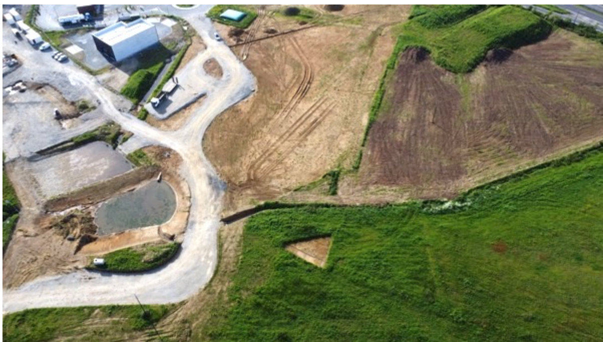
Bassin d'orage très récent de la tranche 1 du projet et fossé d'évacuation - Source : Photo prise par drone – JF SEROT, 2023
