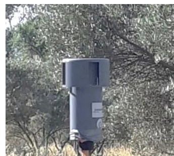
Figure 46 : Principe de l'échantillonneur passif Passam
