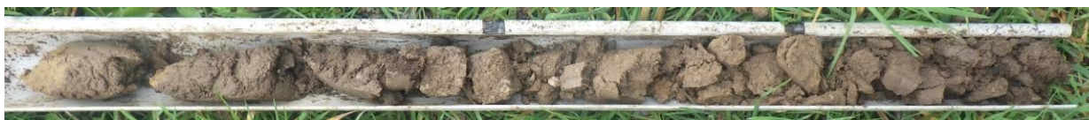
Sondage n°15 : Traces rédoxiques visibles avant 25 cm, sondage complet (Classe Vb : zone humide)
