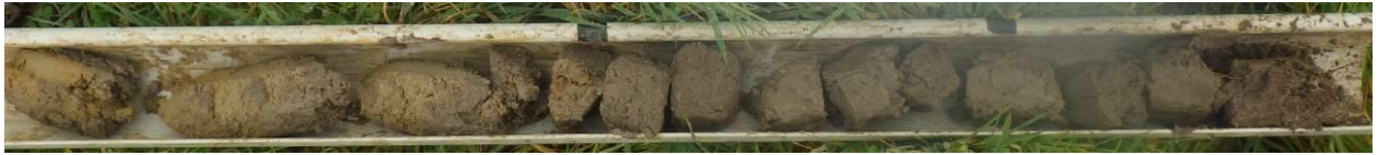
Sondage n°10 : Traces rédoxiques visibles après 50 cm (Classe IIIb : non zone humide)
