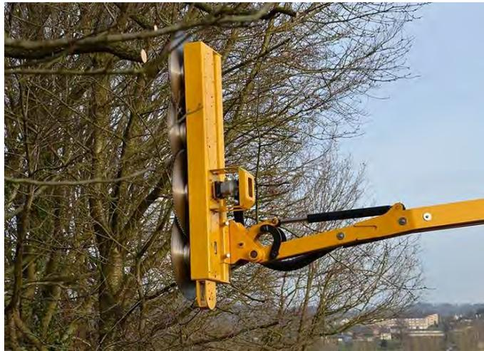
Photo 13 : *Illustration d'un lamier à scie*
