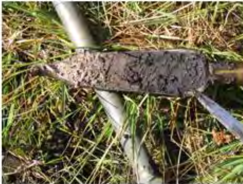
Photo ALD 3181 – plancher limono-tourbeux sur sables
