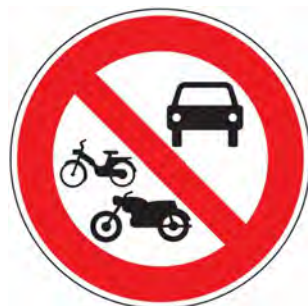
Figure 2 : Panneau B7B d'interdiction de circulation de véhicule à moteur
