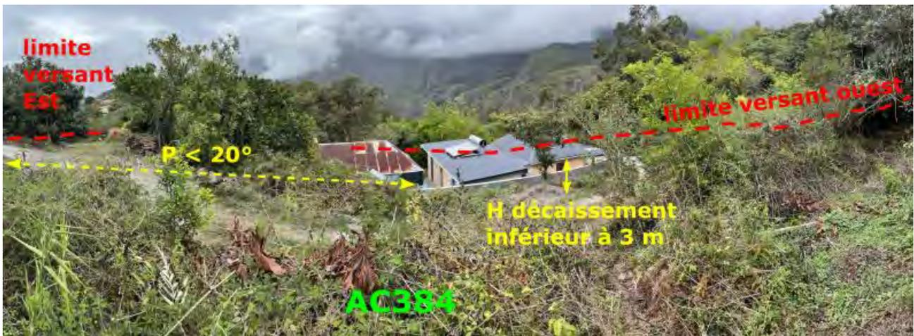
Figure 16 – Configuration des terrains au niveau de la parcelle AC384
