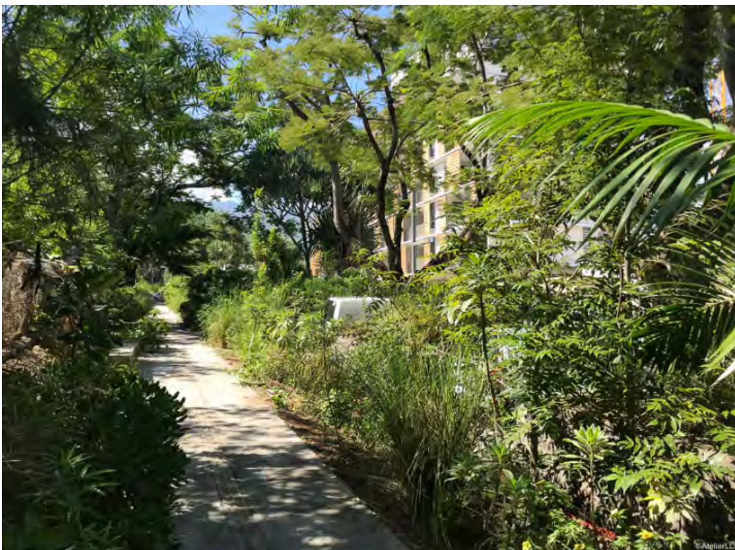
Aménagement Cœur de ville à La Possession Les trottoirs sont séparés des rues par une bande de plantations et des noues paysagères. L'ambiance est propice à la marche.
