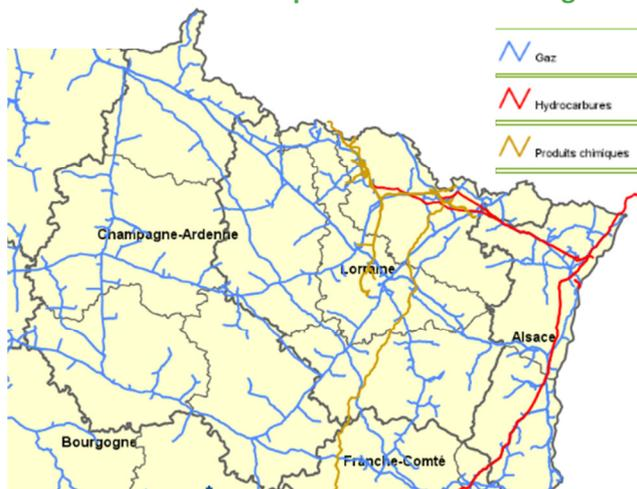
Cette cartographie comporte uniquement les réseaux de transport (réseaux de distribution non représentés) soumis à la mise en place d'un système d'information géographique (SIG) conformément à l'arrêté multifluide du 4 août 2006 modifié.
