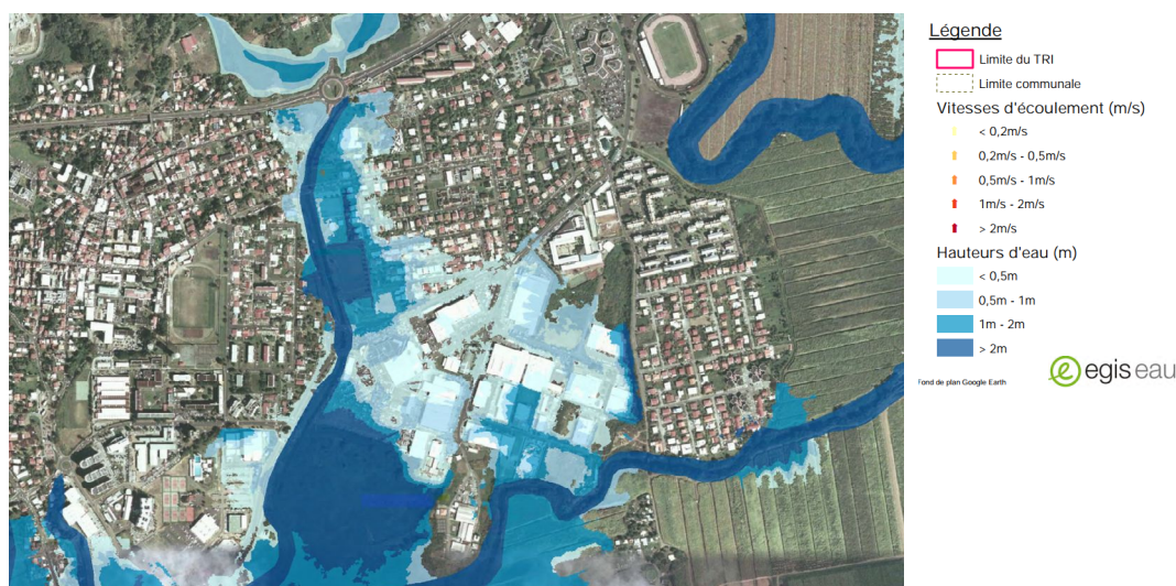
Figure 23: Extrait carte d'aléa débordement de cours d'eau – hauteurs d'eau pour une crue de récurrence 10 ans (scénario fréquent) – commune du Lamentin – zoom sur la zone de Place d'Armes
