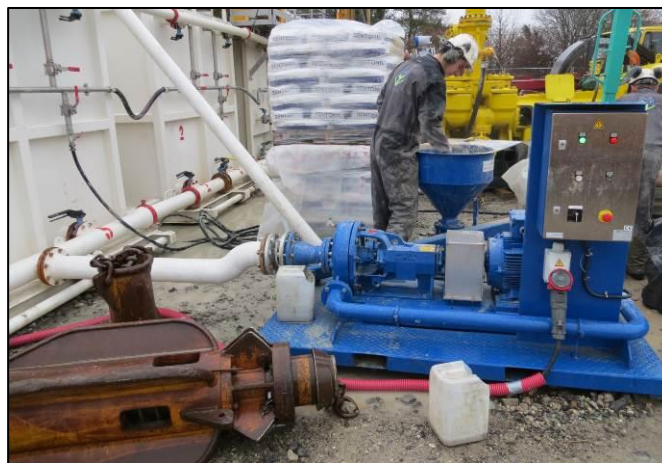
Figure 10 : Hopper relié aux bacs à boue (bacs blancs)
