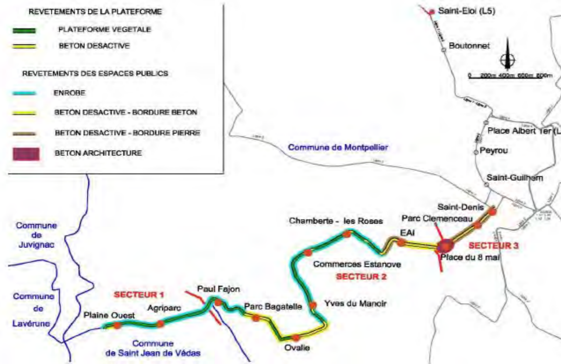
FIGURE 29 : RETEVEMENTS (SOURCE : AVP T5 OUEST, 2021)
