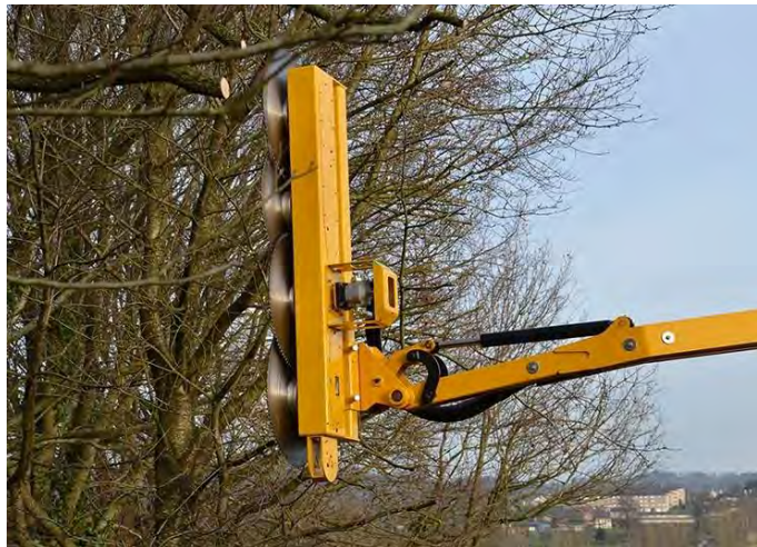
Photo 13 : Illustration d'un lamier à scie
