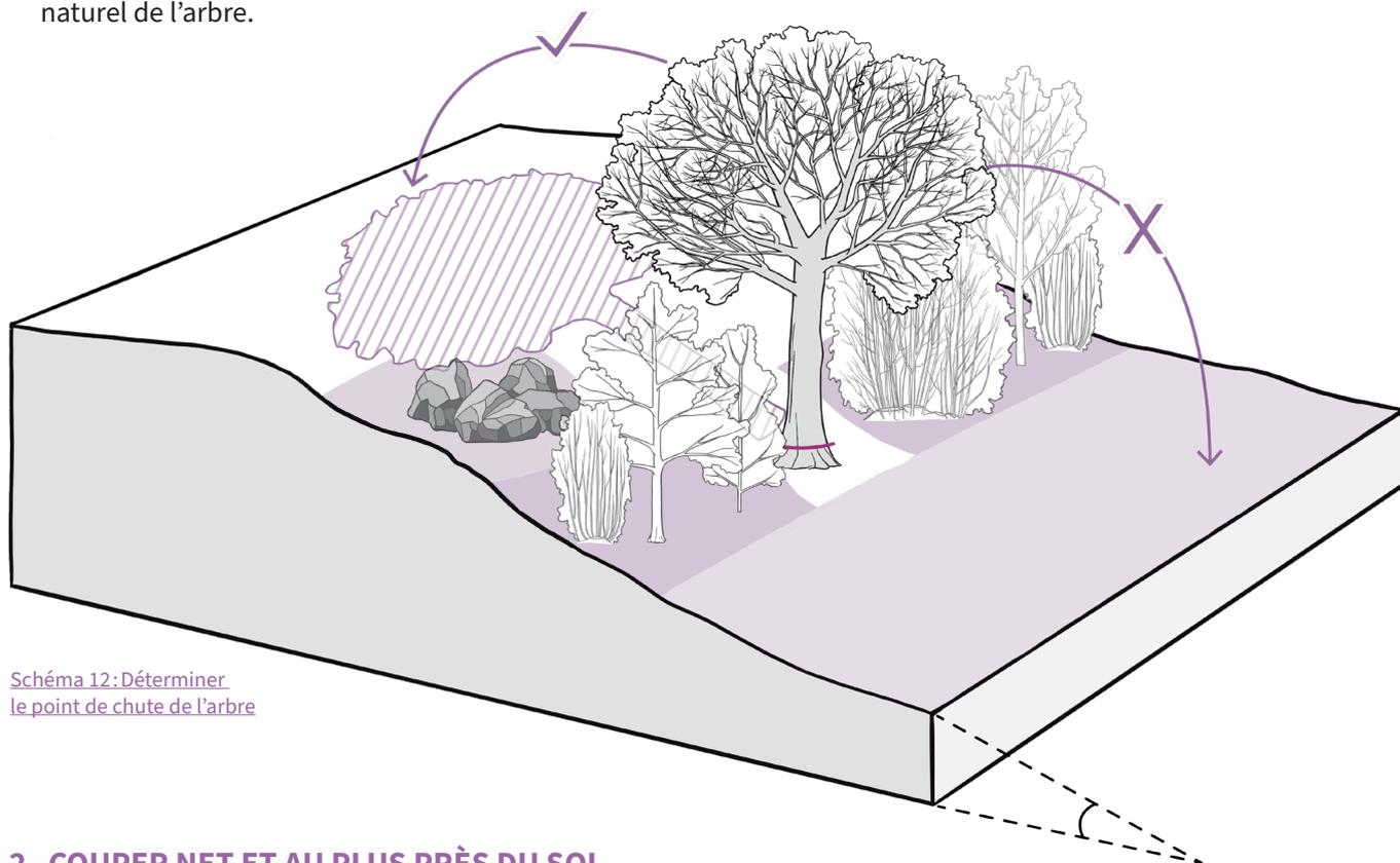
Schéma 12: Déterminer le point de chute de l'arbre
