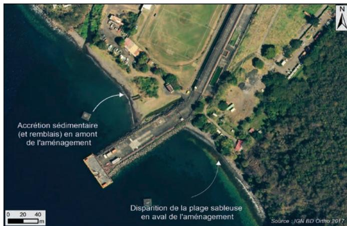
▲ Incidence de l'implantation d'un épi transversal sur le blocage du transit sédimentaire sur la commune de Bellefontaine. © BRGM
