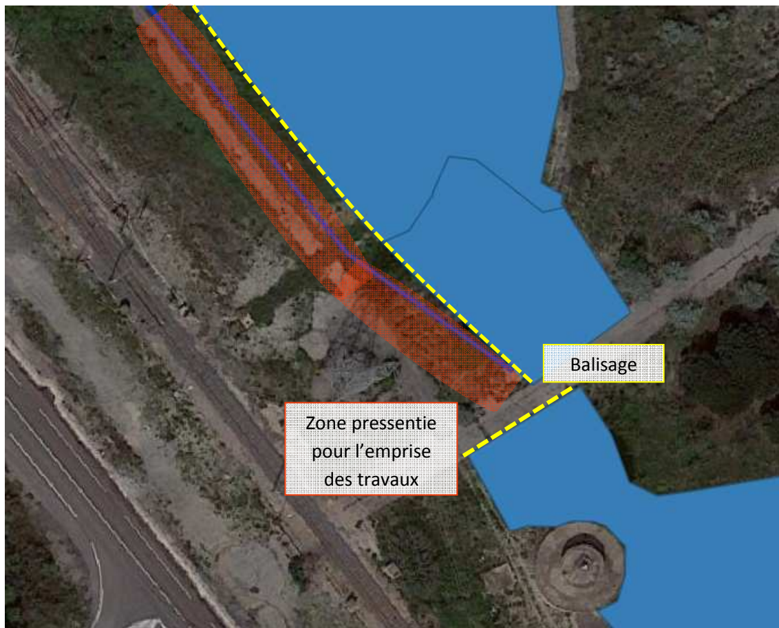
Figure 45 : Décalage de l'emprise des travaux afin d'éviter tout impact sur les zones humides
