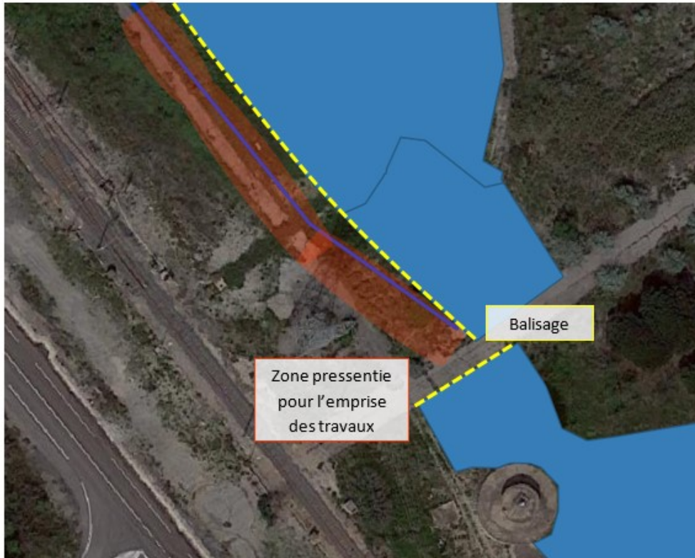
Evitement par décalage et réduction des emprises chantier + mis en défens (zones humides sud du tracé)
