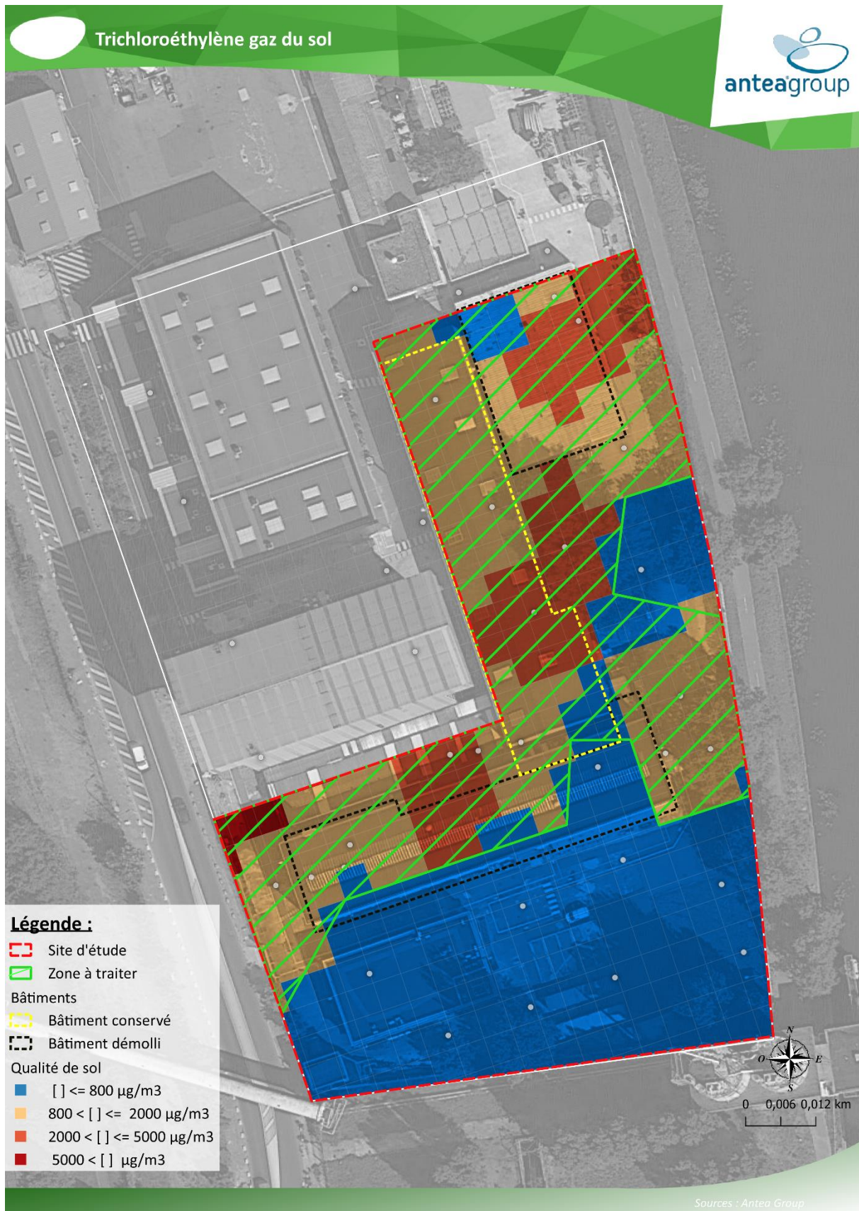
Figure 25 : Carte d'interpolation des résultats en TCE dans les gaz du sol et délimitation de la zone à traiter
