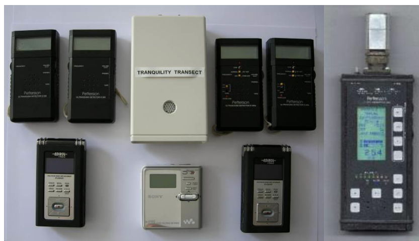
Détecteurs-amplificateurs d'ultrasons et enregistreurs numériques utilisés lors de l'étude
