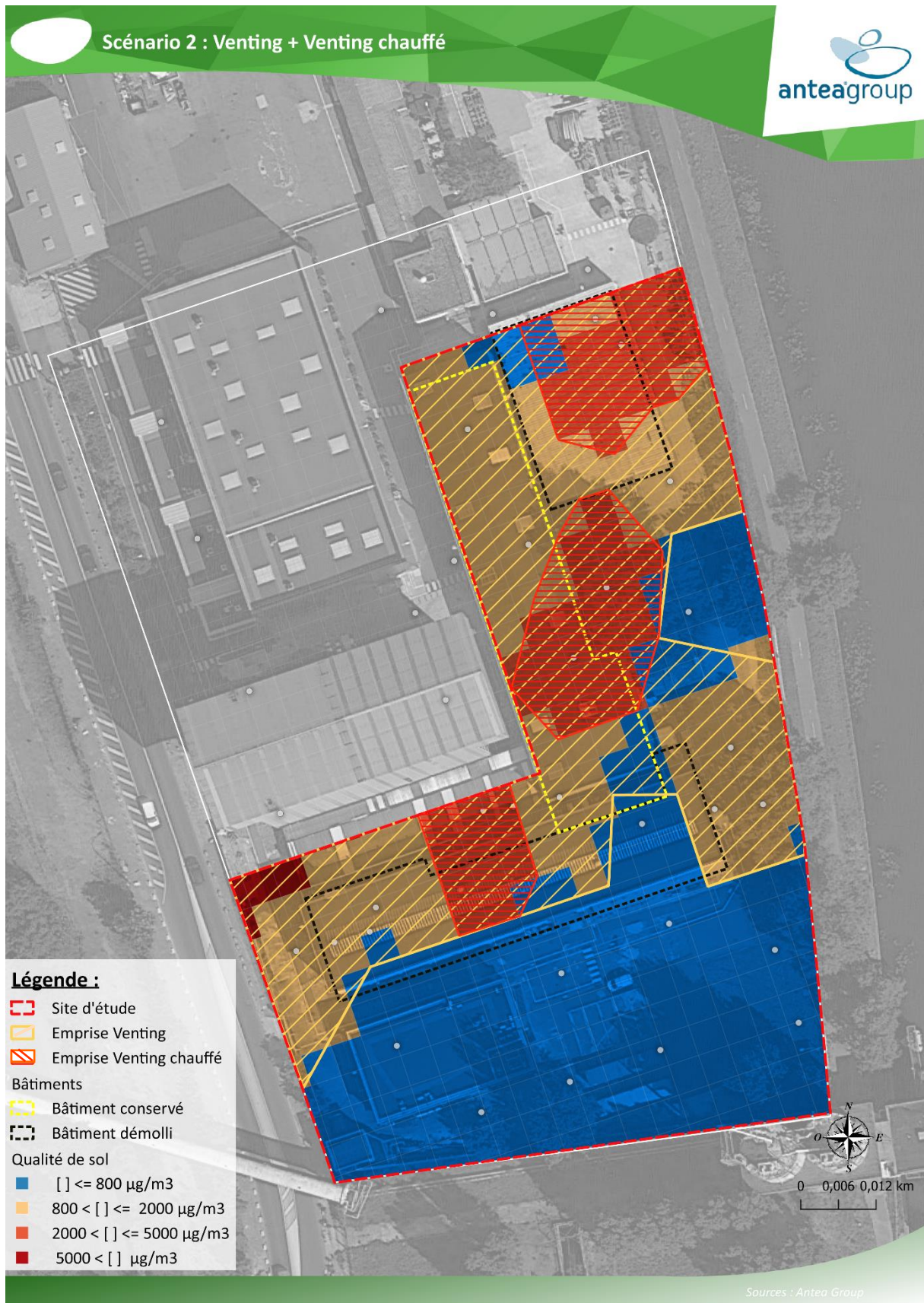
Figure 31 : Scénario 2 - zones de traitement par venting et venting chauffé
