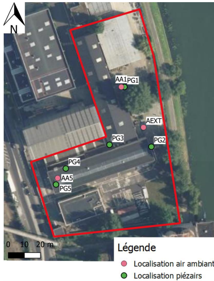
Figure 7 : Localisation des prélèvements de gaz du sol et d'air ambiant – rapport ICF A1057 d'août 2020
