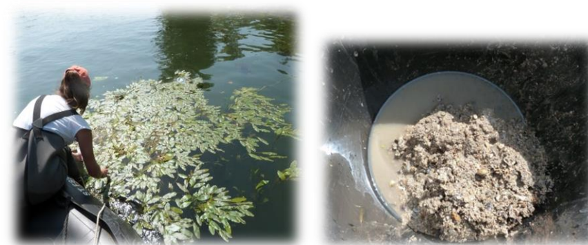
Figure 4 : Prélèvement de végétation au filet Surber (en haut) et substrat récolté par dragage au fond du chenal (en bas) dans la Seine à Vitry-sur-Seine (Photos : DUBOST Environnement)
