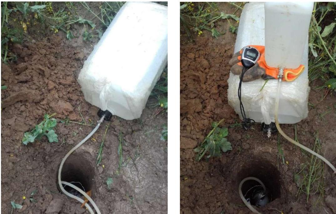
**Figure 9 et 10 : Sondages en cours de saturation et mesure**
