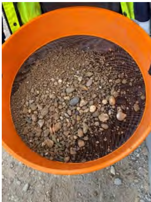
Tamissage des matériaux extraits maille de 2 mm
