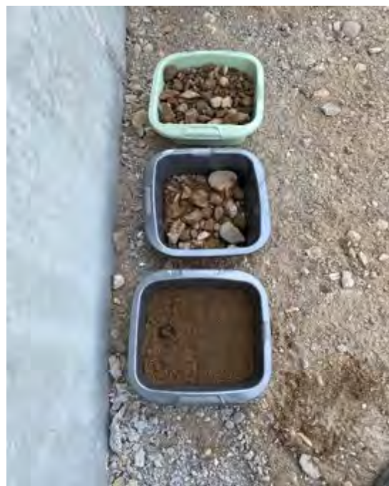
Séparation par tamisage des matériaux
