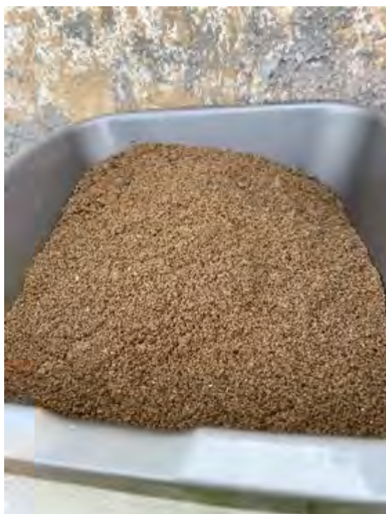
Matériau obtenu après tamisage à 2 mm
