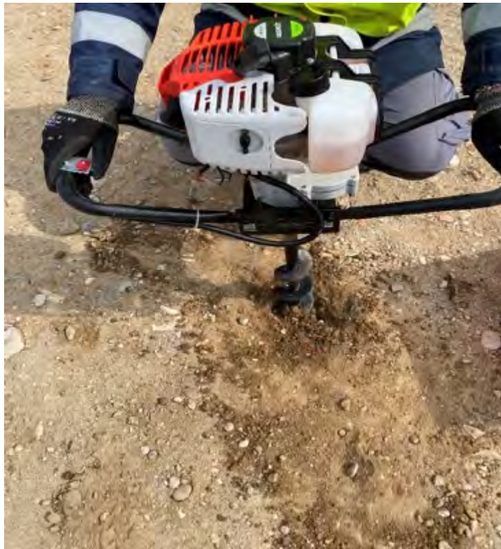
Photographie 3 : Prélèvement à la tarière thermique
