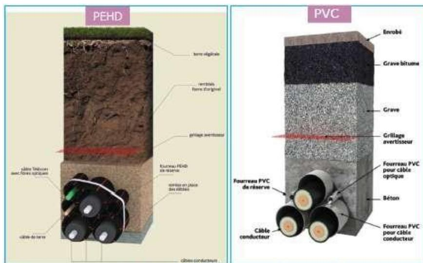
**Figure 10 : Exemples de coupe de liaison souterraine à 225 000 volts**
