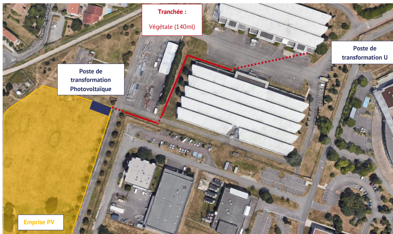
Figure 22 Vue aérienne des tranchées à réaliser entre la zone 3 et le poste transformation U
