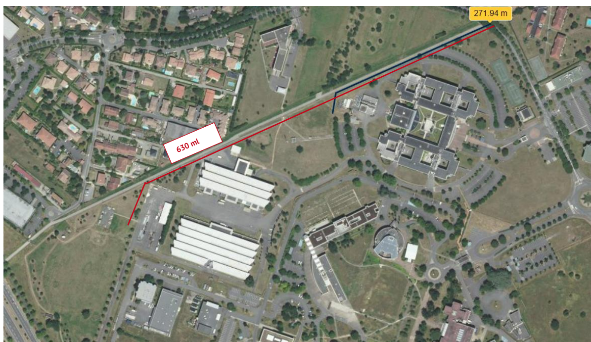
Figure 15 Tranchée nécessaire à la mise en place du raccordement fibre
