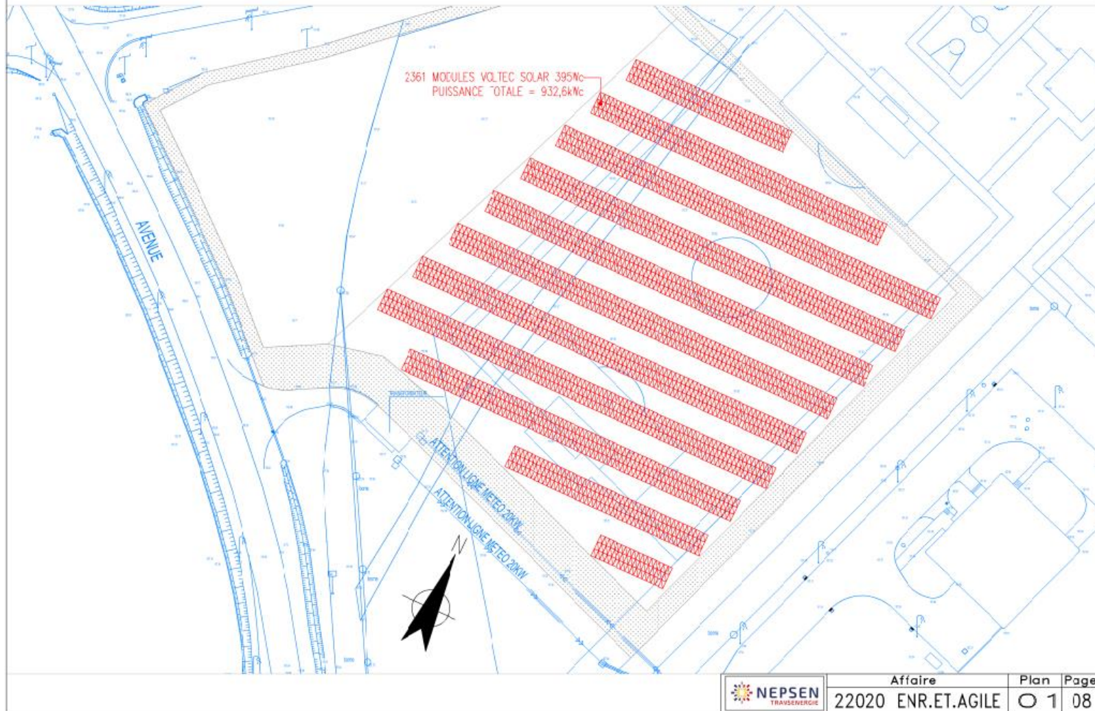
Figure 12 Implantation des modules photovoltaïques sur micropieux sur la zone 3 – Scénario 3
