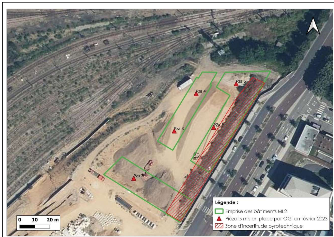
Figure 7 : Plan d'implantation définitif des piézairs
