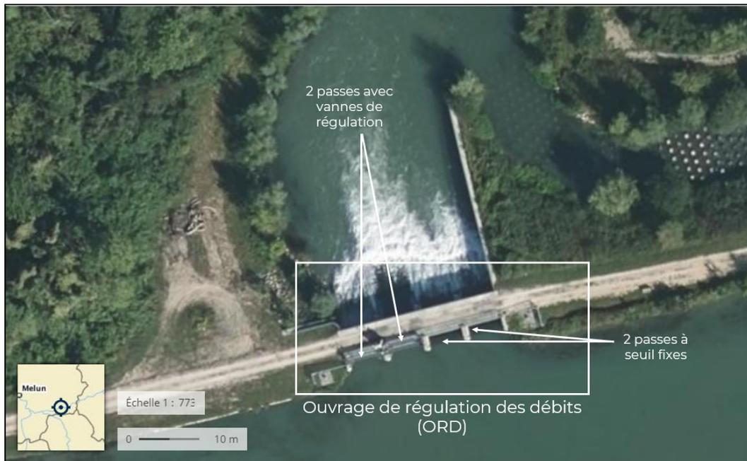
*Vue en plan de l'ouvrage de régulation des débits (Source : Géoportail, échelle 1 / 773)*
