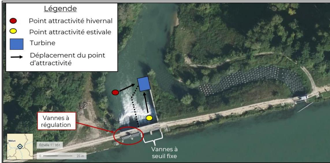
*Renforcement de l'attrait de la passe à poissons par la mise en place d'une turbine à proximité directe de l'entrée piscicole (Source : Géoportail, échelle 1 / 951)*
