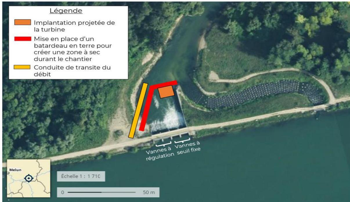
*Figure 12 : Alternative de mise à sec par by-passing*
