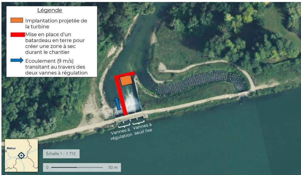
*Figure 11 : Alternative de mise à sec par la mise en place de batardeaux en terre*
