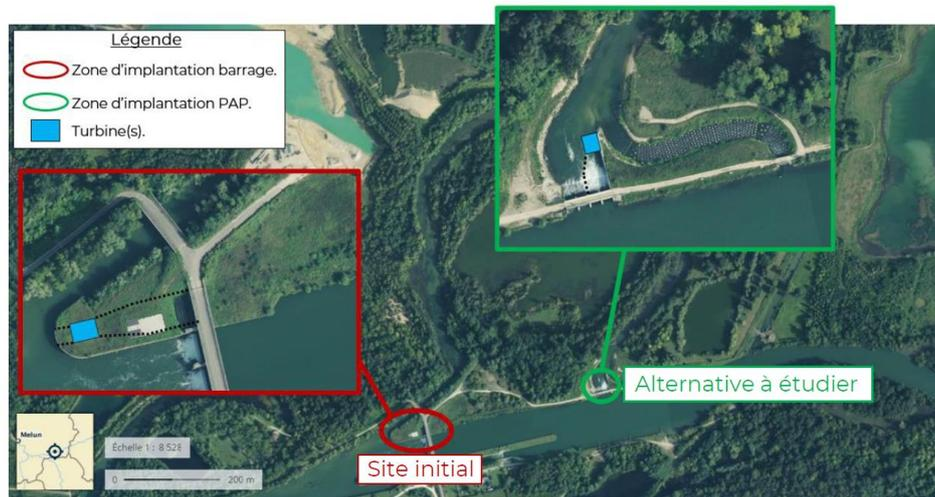
*Vue en plan du projet initial d'équipement hydroélectrique du barrage de Grande-Bosse et de l'alternative suggérée par les services de l'Etat, finalement retenue (Source : Géoportail, échelle 1 / 8528)*
