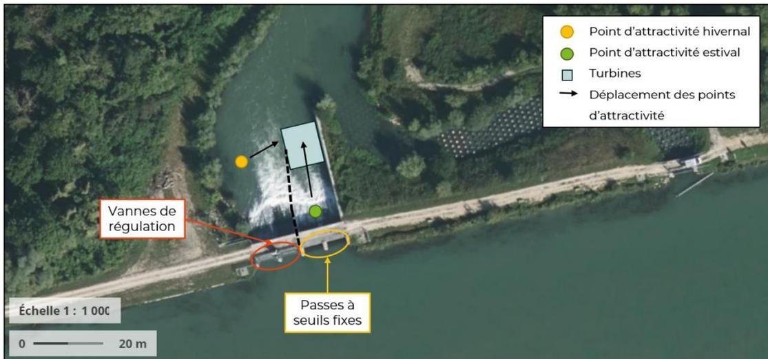
*Renforcement de l'attrait de la passe à poissons par la mise en place de turbines à proximité directe de l'entrée piscicole (Source : Géoportail, échelle 1 / 1 000)*
