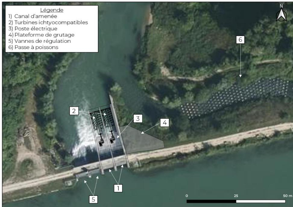
*Vue en plan – Implantation des turbines (Source : VALOREM)*
