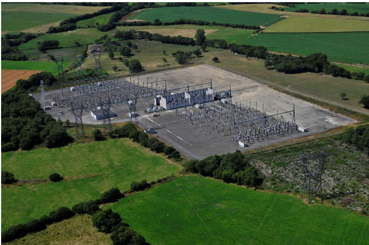
*Figure 10 : Exemple d'un poste 400 000 / 225 000 volts*
