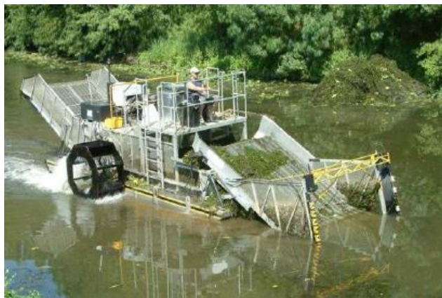
Figure 7 : Photographie d'un bateau faucardeur
