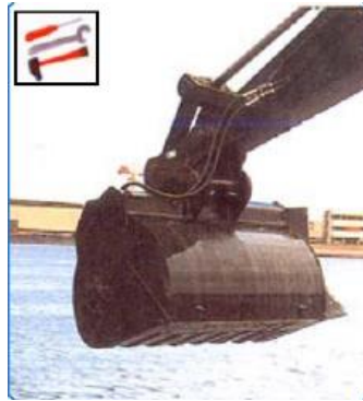
Figure 5 : Illustration d'un godet obturable
