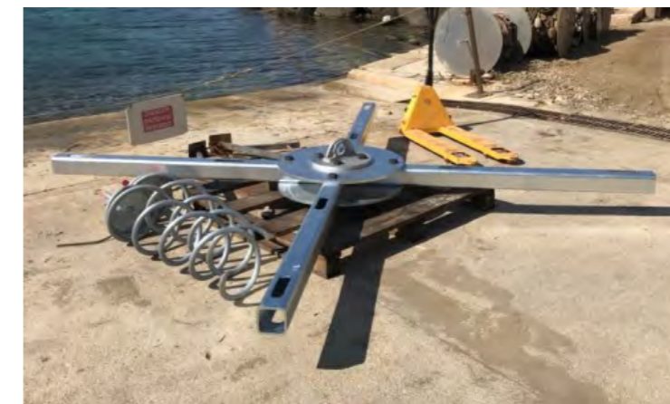
Illustration 39: Exemple d'un palonnier à 8 vis (grandes unités de la ZMEL de Bagaud, 2020)
