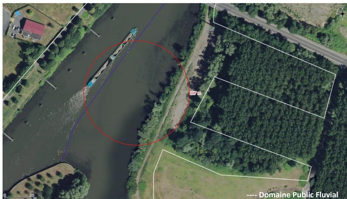
Figure 1 : Zone bénéficiant d'une légère sur largeur pour le virement des bateaux sur le bief Bruay-Fresnes
