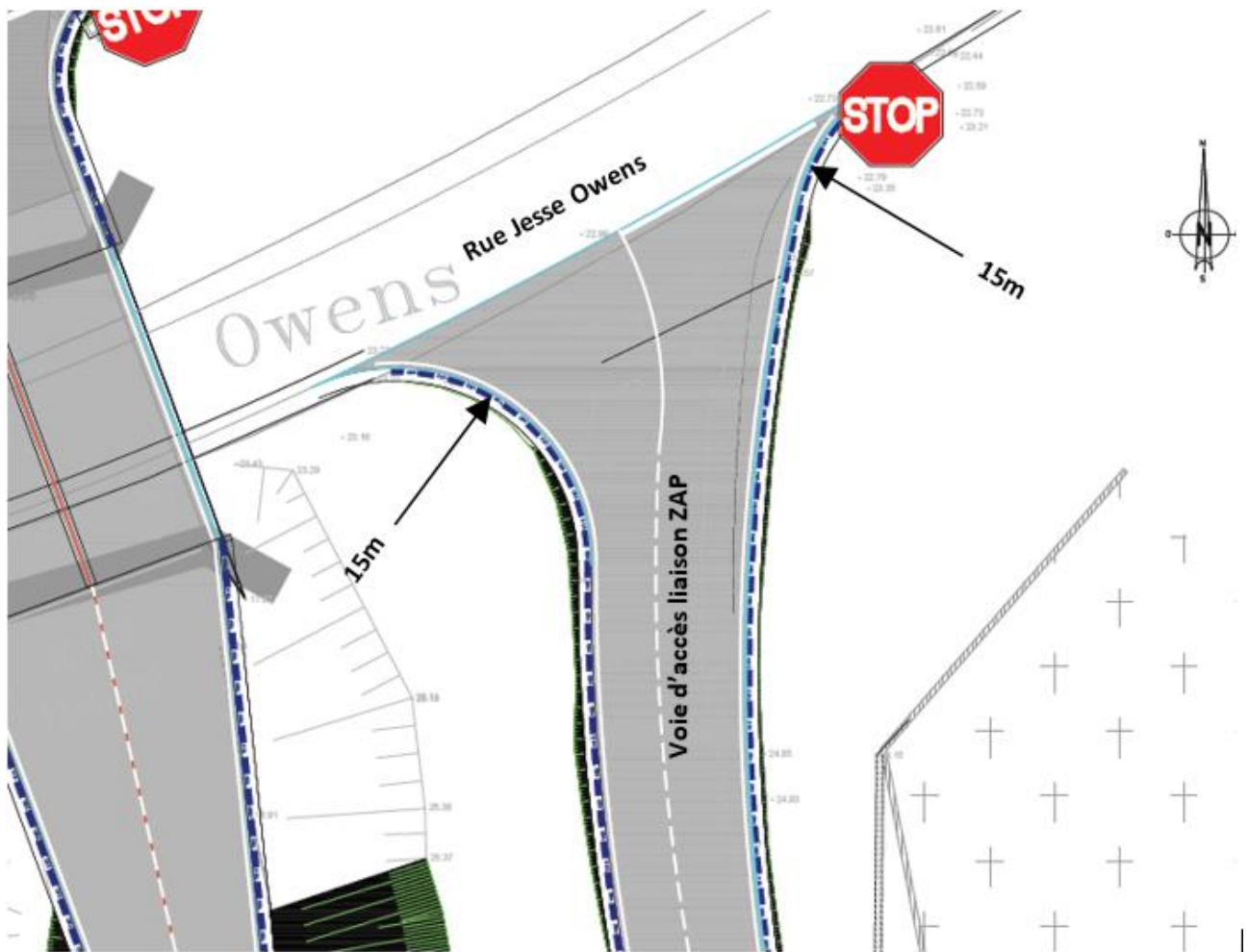
Figure 8 – Raccordement sur la voie intraportuaire
