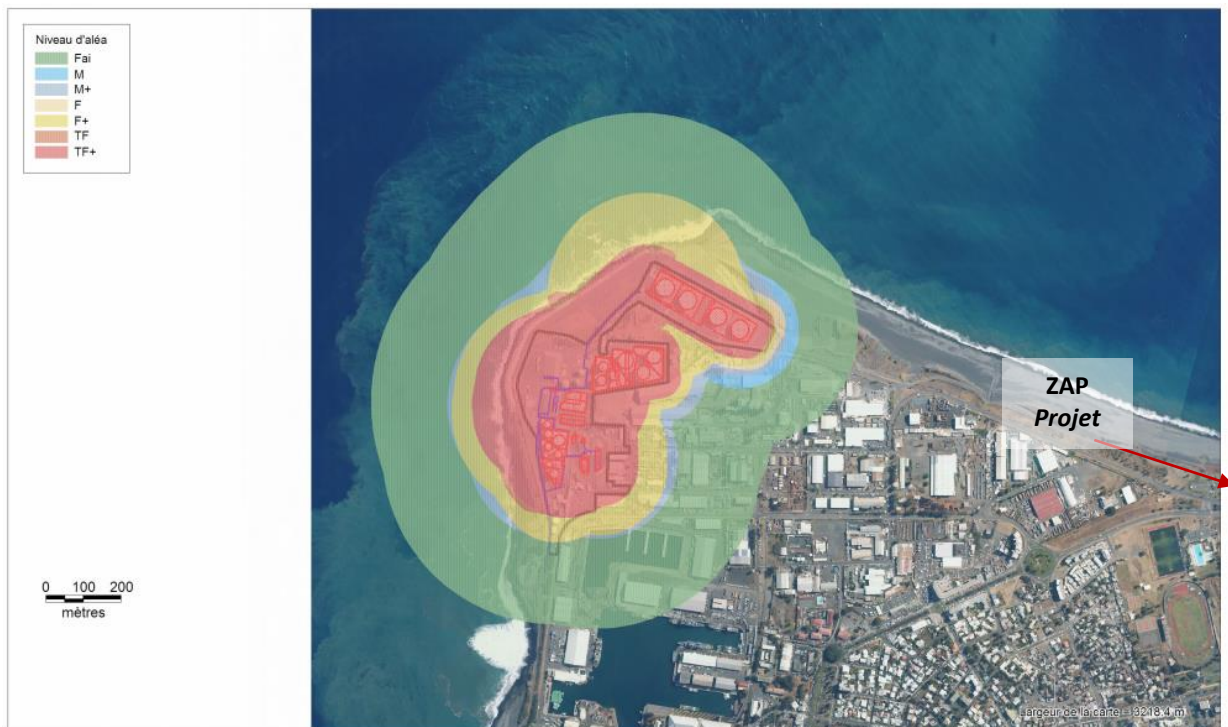
Figure 41 – Extrait de la cartographie du zonage réglementaire du PPRT relatif au dépôt pétrolier SRPP de la commune du Port
