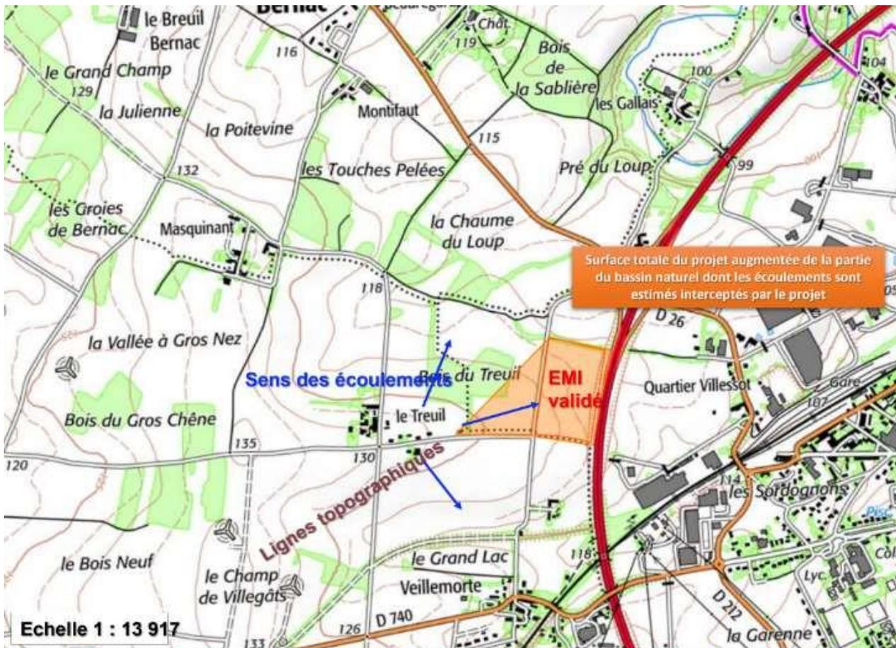
Estimation de la surface totale du projet du poste de transformation électrique augmentée de la partie du bassin naturel dont les écoulements sont interceptés par le projet (selon topographie de l'IGN)
