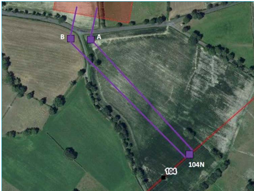
Principe de raccordement aérien du poste
