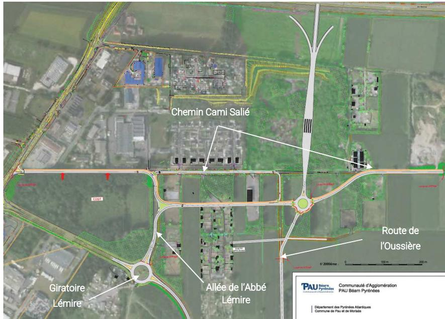
Une liaison directe est créée entre le giratoire de sortie de l'A64 et l'allée de l'Abbé Lémire, via une voie nouvelle et sans la réalisation de giratoire intermédiaire, de manière à desservir plus efficacement les terrains situés de part et d'autre de cette voie nouvelle.
