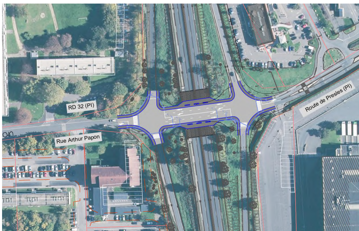
Figure 21 – Schéma d'aménagement des carrefours à feux
