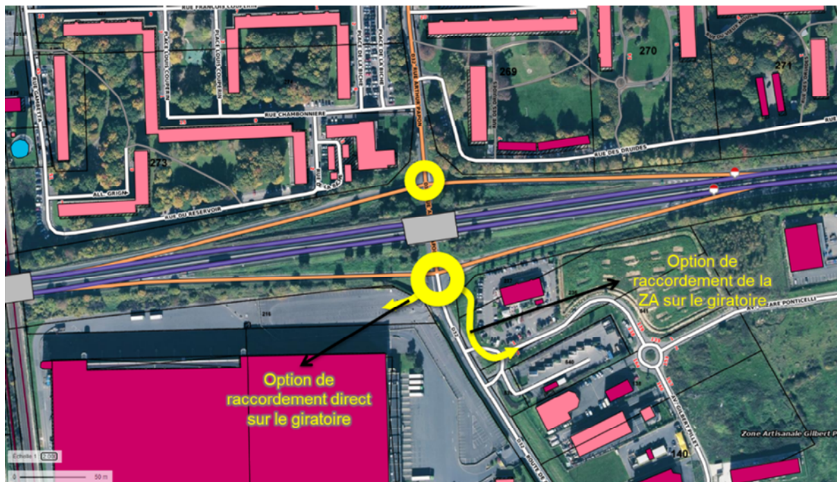
Figure 12 – solution 5a : aménagement de carrefours giratoires
