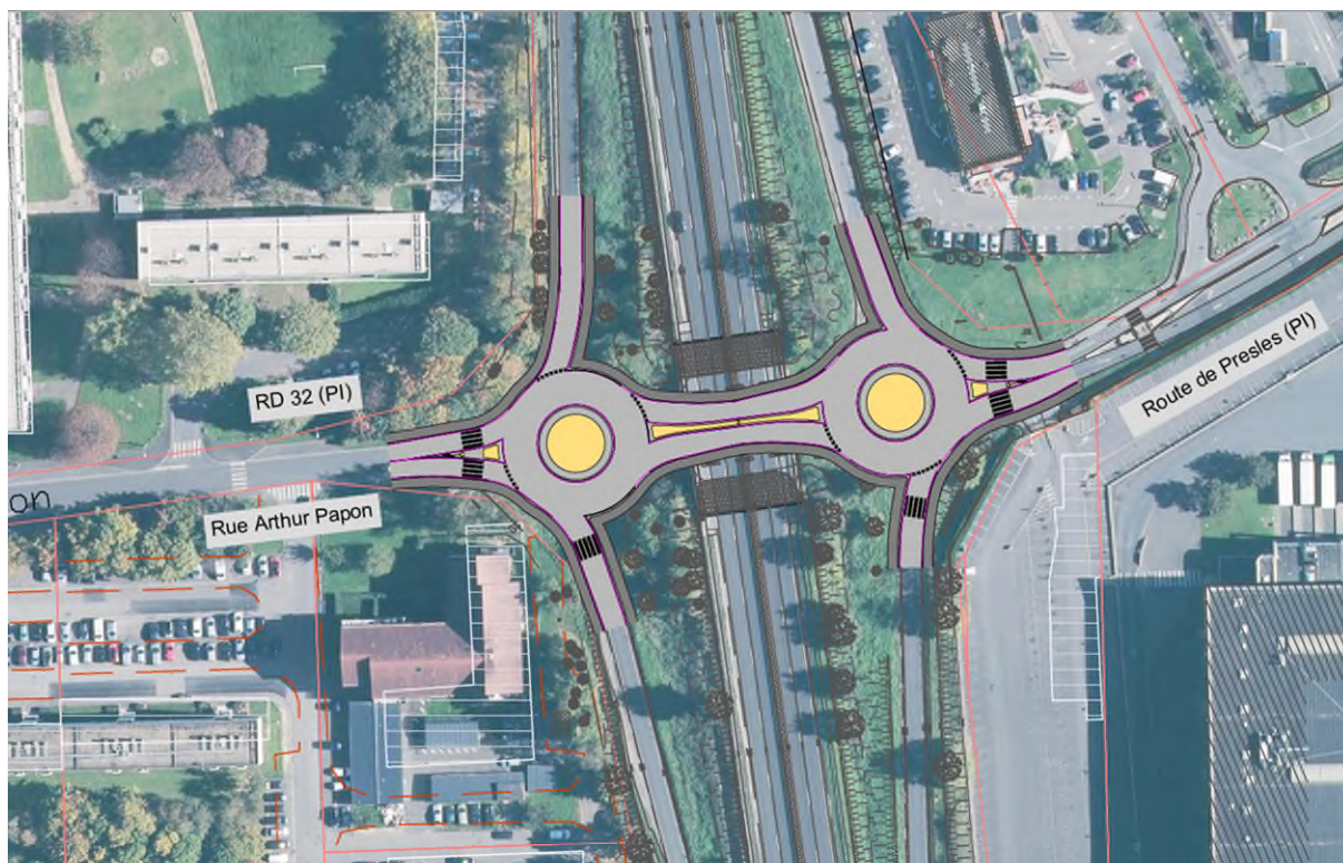
Figure 20 – Schéma d'aménagement des carrefours giratoires
