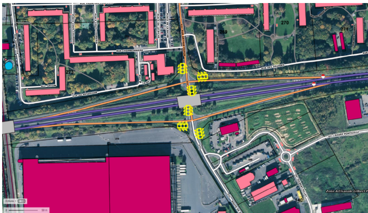
Figure 13 – solution 5b : aménagement de carrefours à feux
