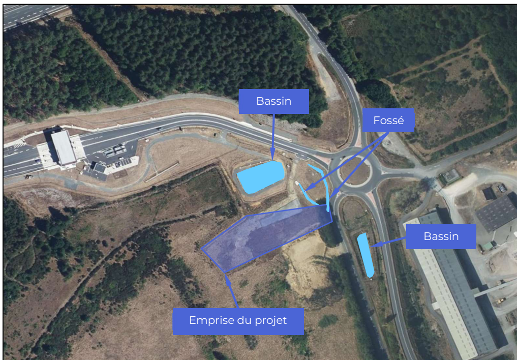
Figure 2 : Localisation des ouvrages EP aériens
