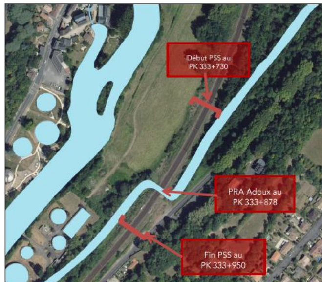
Figure 1: Délimitation du remblai classé ouvrage sensible (PSS) (Source : Géoportail)
