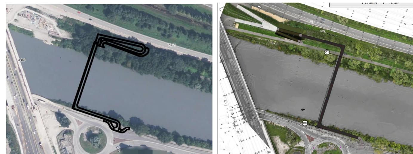
Figure 9 : Implantation initiale de la rampe en rive droite (à gauche) et modification de projet au profit de l'utilisation des aménagements existants (à droite)
