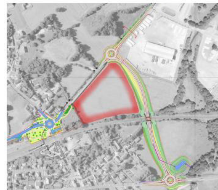
Figure 14. Zone de stockage provisoire de la terre végétale – Source AVP CD53 – avril 2025
