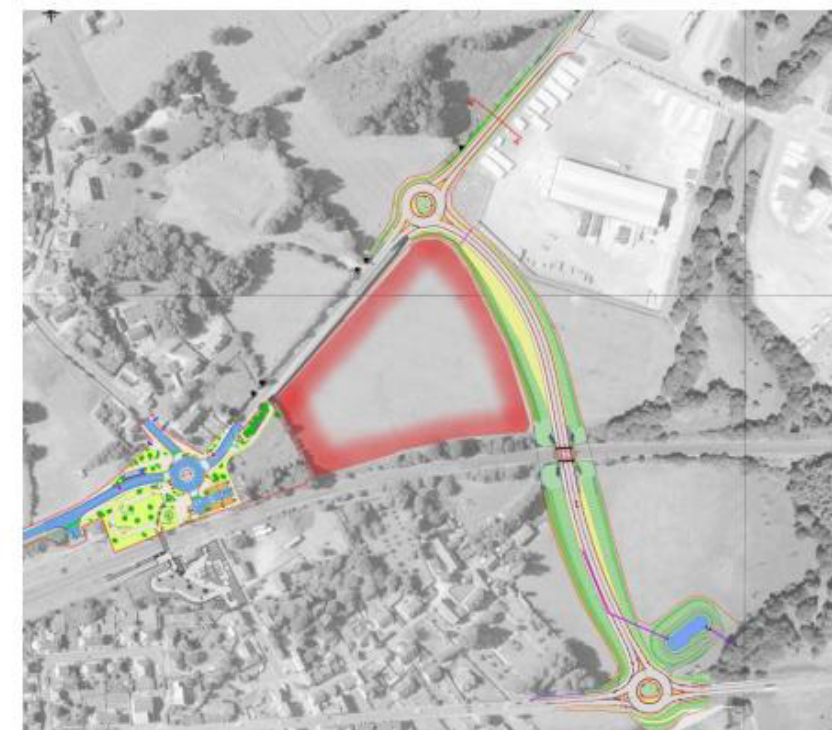
Localisation du stockage provisoire de la terre végétale
