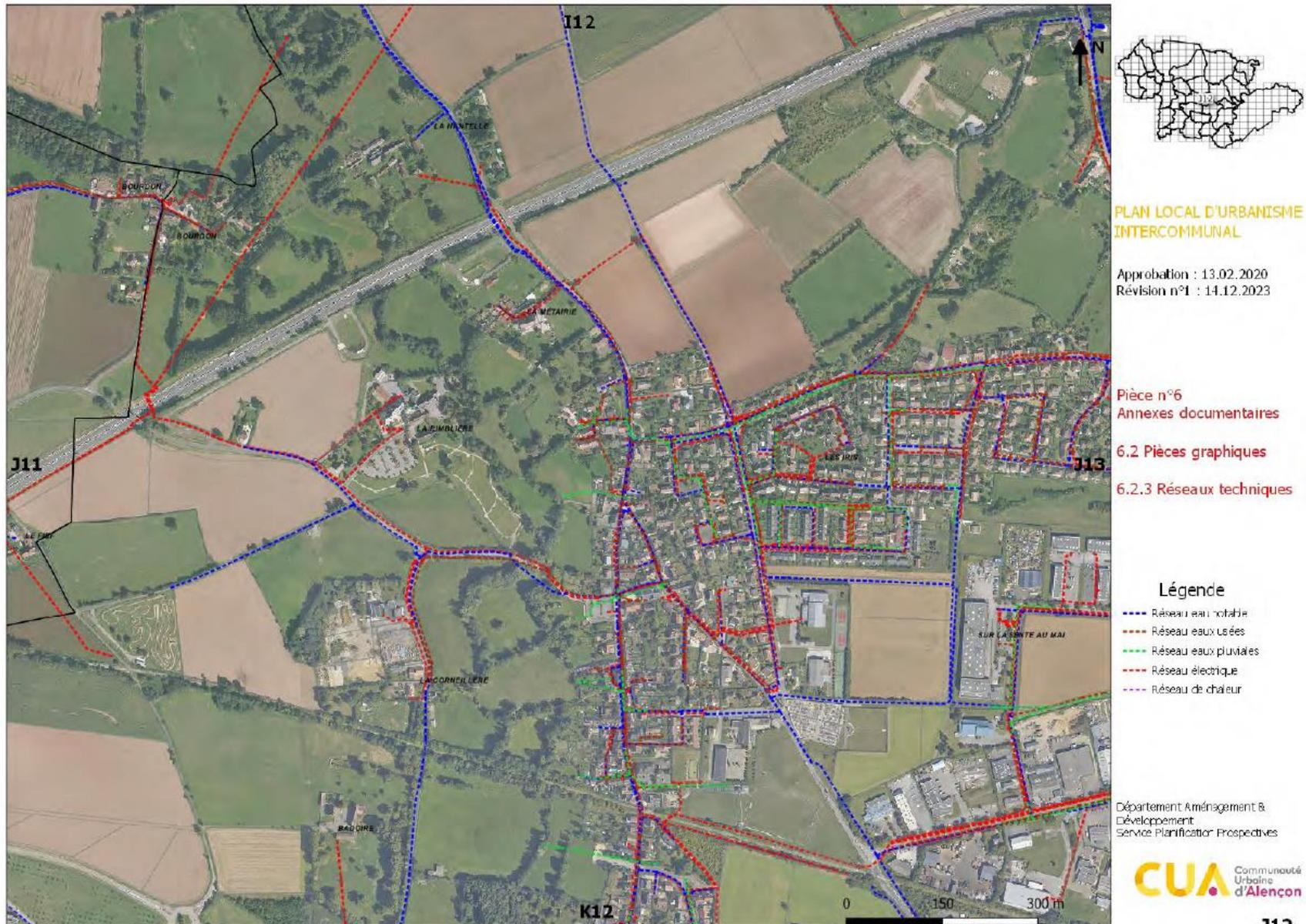
Figure 44 : Les réseaux techniques identifiés sur le site de Damigny.
