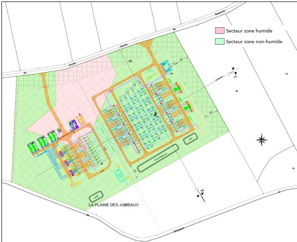
Figure 4 : Plan général d'implantation du futur poste et des zones humides du site selon le critère pédologique (Source : délimitation zones humides, ECR Environnement, Octobre 2024)
