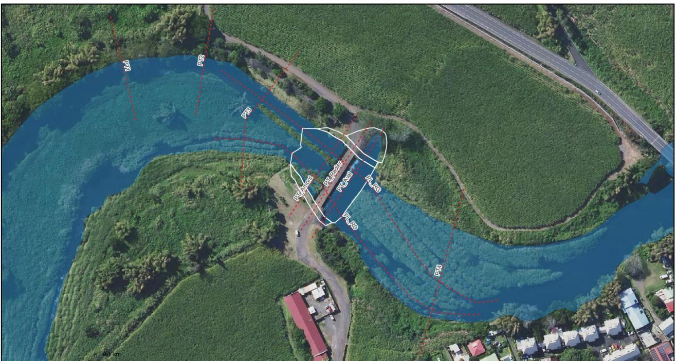
Figure 41 : Emprise des travaux de terrassement du lit et des berges pour la solution 1
