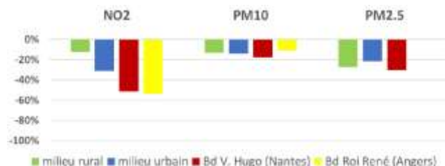
Figure 26 : Estimation sur la période de déconfinement (entre le 11 et 24 mai 2020) de la réduction des concentrations en \text{NO}_2 et particules fines \text{PM}_{10} et très fines \text{PM}_{2.5}
